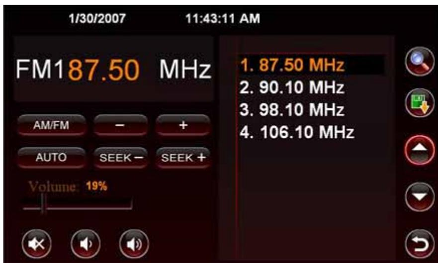
Das Panel des 7" Displays ist von Sharp und zeugt daher von hoher Qualität. Die native Auflösung beträgt 800x480 Bildpunkte, während die Leuchtdichte bei 400nits liegt. Der Touchscreen reagiert sehr schnell auf Eingaben und arbeitet auch mit dem Finger äußerst präzise. Leider spiegelt die Oberfläche des Displays ein wenig. Bei direkter Sonneneinstrahlung könnte es zu Ableseschwierigkeiten kommen.
