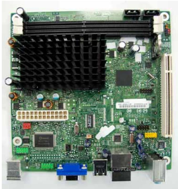
Für zusätzlich benötigte Anschlüsse ist das D410PT mit einer ausreichenden Anzahl an Onboard Steckplätzen versehen. Somit finden sich hier, 4 USB, 2 Serielle Steckplätze und 1 PCI Steckplatz.
