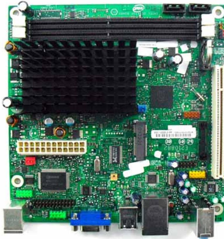
Das D510MO bietet hier noch etwas mehr, so wurde hier zusätzlich zu den 4 USB, 2 Seriellen und dem PCI Steckplatz, ein paralleler, ein Mini PCIe und ein LPT Sockel hinzugefügt.
