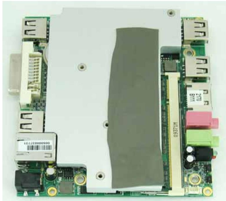
Wenn der Kühlkörper befestigt wurde, können Sie die SATA Festplatte, an den vorgesehenen Steckplatz positionieren und einrasten
