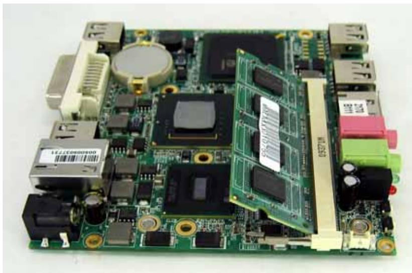
Setzen Sie den RAM ein und drücken Sie ihn nach unten bis der RAM eingerastet ist.
