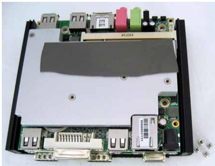
Halten Sie das untere Gehäuse mit einer Hand fest und mit der anderen Hand ziehen Sie das Mainboard nach oben
