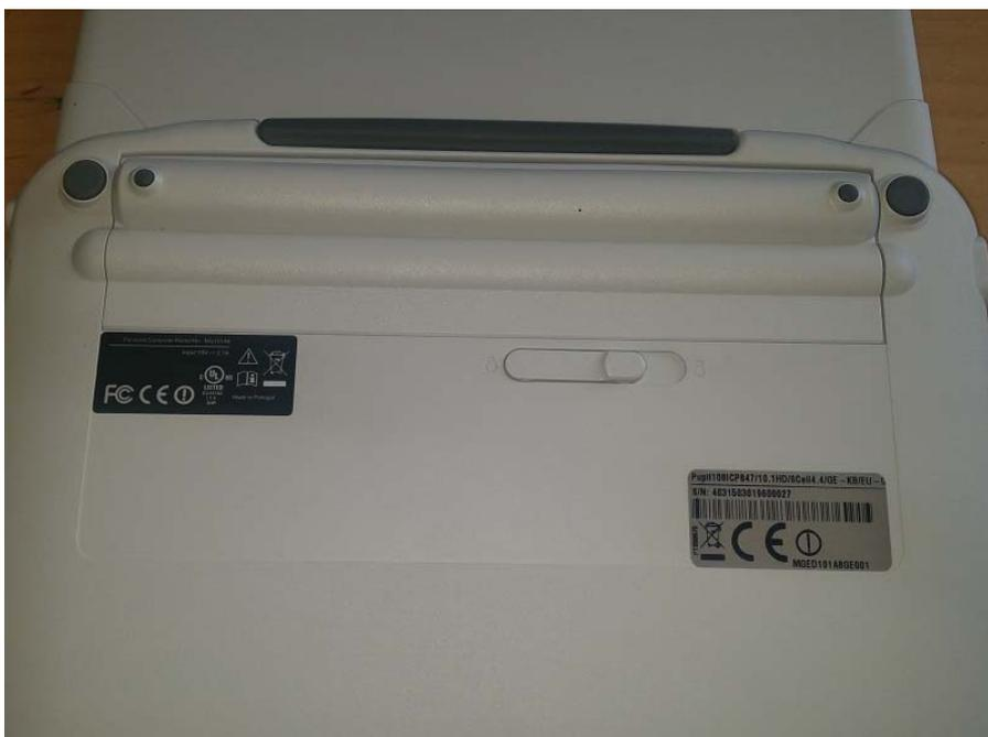
Gerät komplett aufgeklappt umdrehen und den Akku entfernen
