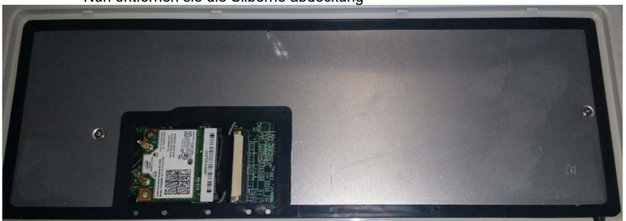
Jetzt können die Komponenten wie RAM / Mini PCIE Karte und HDD eingebaut werden
