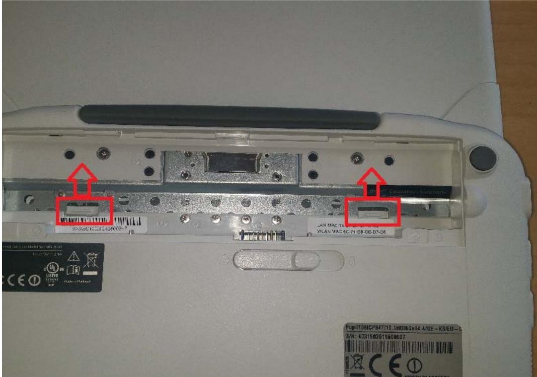
Nun die Beiden Markierten Schieber gleichzeitig in Pfeilrichtung bis zum Anschlag schieben
